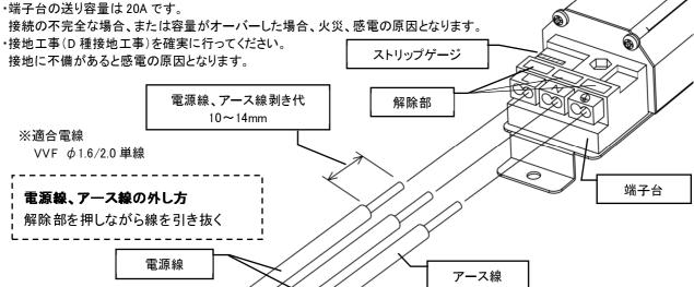
— 被覆外径MAX φ2. 7mm、単線 φ0.5~1.2mm 半田処理より線0.2~0.75sq(仕上り外径MAX φ1.4mm)
