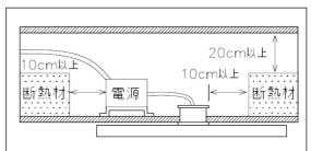
電気配線は断熱材・防音材の上を通してください。
