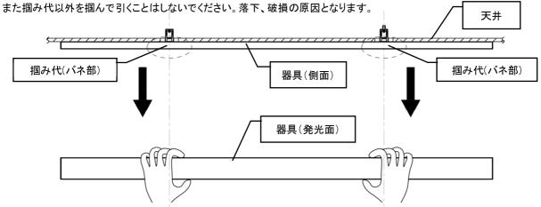
・器具背面に挿入されている DC ハーネスのロック部を押しながらコネクタを抜いてください。 この際、器具を落下させないように器具を手にもって作業してください。 破損、落下の原因となります。
